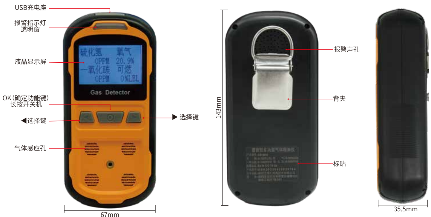
外观尺寸:143mm×67mm×35.5mm(长x宽x高)
