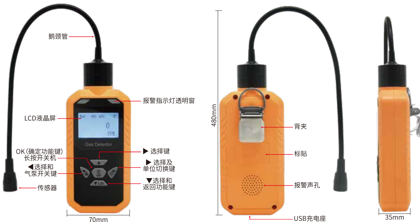
外观尺寸:480mmx70mmx35mm(长x宽x高)
